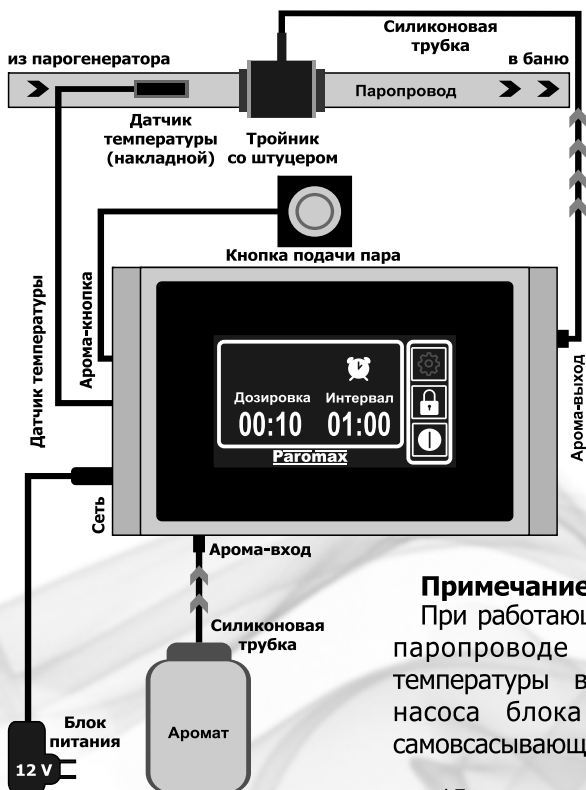
Рис. 2. Схема подключения диспенсера ароматов
