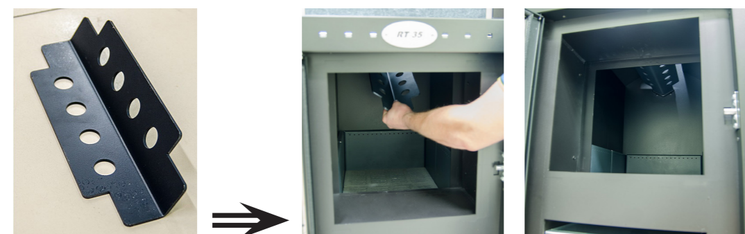
5) Установка рассекателя пламени.
