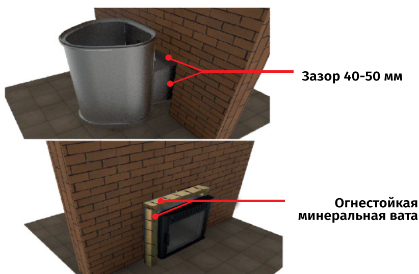
Рис.№ 5 Установка печи «Сквозь стену»
