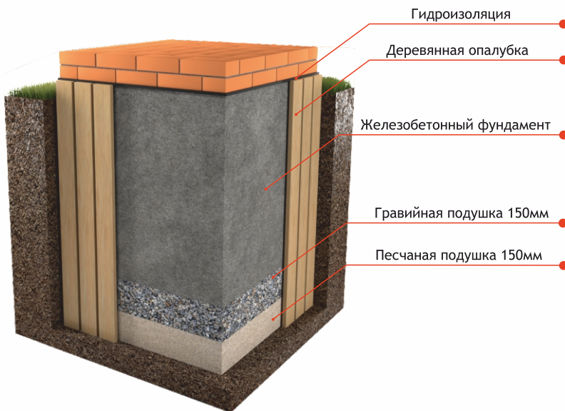
Рис. 3 Схема устройства фундамента
